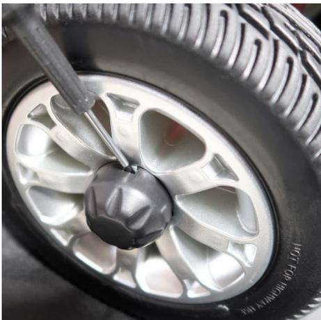
Zum Entfernen der Radkappe verwenden Sie einen spitzen Gegenstand (z.B. Schlitzschraubendreher). Hebeln Sie die Radkappe leicht an.
