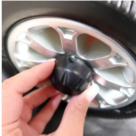
Richten Sie die Aussparungen der Radkappe so aus, dass die Kappe in das Rad reingedrückt werden kann.
