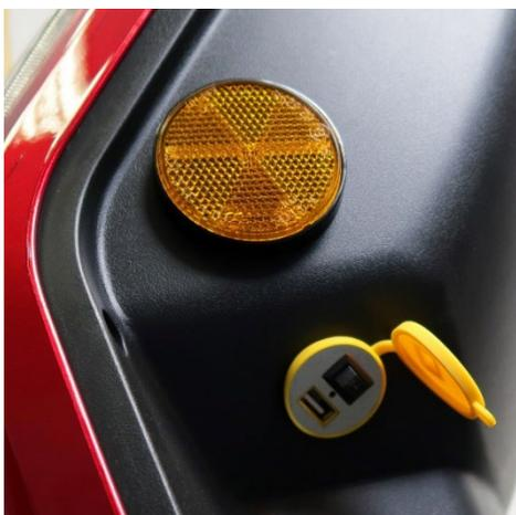
Die USB-Ladebuchse befindet sich an der vorderen Konsole, unter dem orangenen Reflektor.
