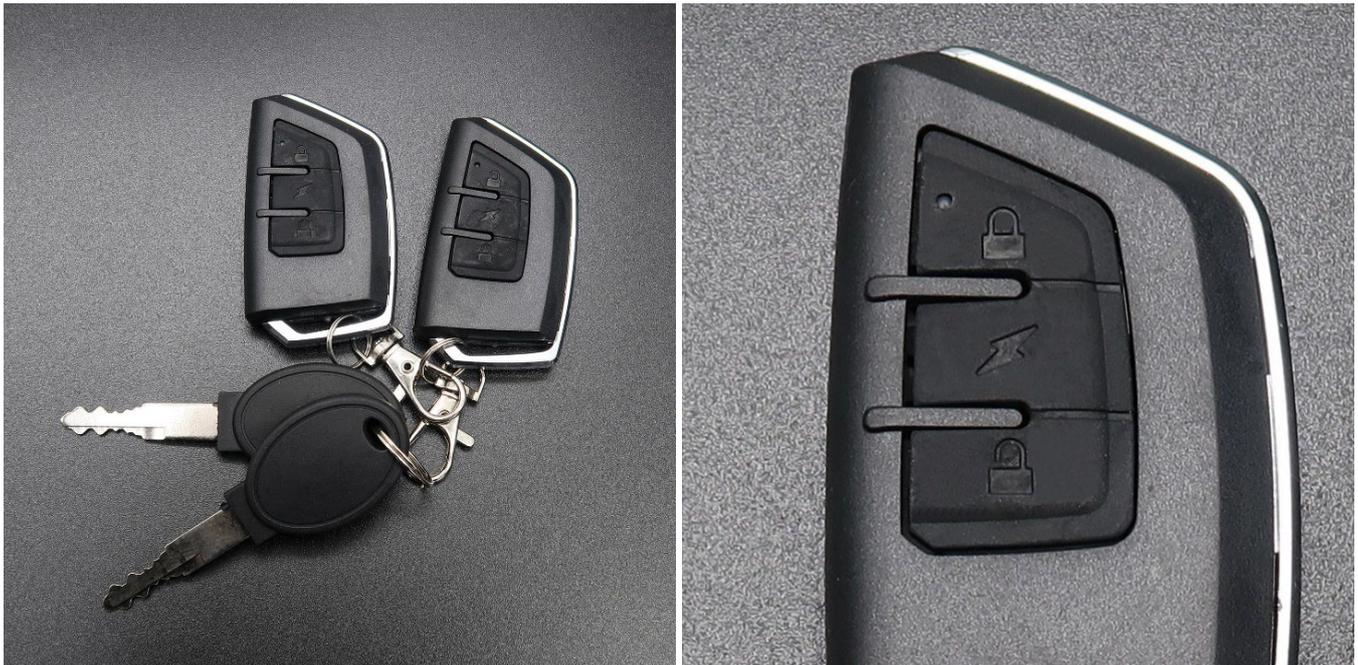
Mit der oberen Taste
