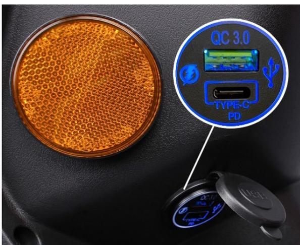
Die USB-Ladebuchse befindet sich an der vorderen Konsole, direkt unter dem orangefarbenen Reflektor.
