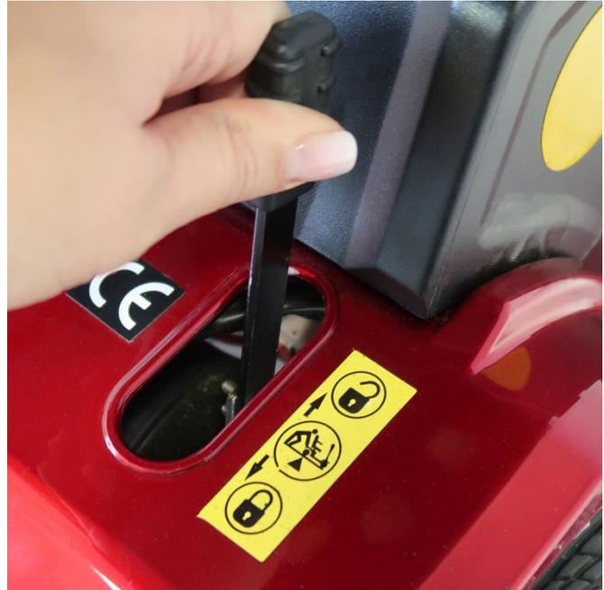
Wenn der Hebel nach oben zeigt (Schloss geöffnet), kann das Fahrzeug geschoben werden.
